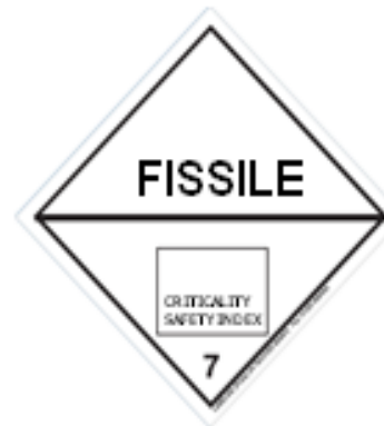
(Nr 7E) Materiały rozszczepialne klasy 7 Białe tło; napis (obowiązkowy): czarny w górnej połowie nalepki: „FISSILE”; w polu z czarną ramką w dolnej połowie nalepki: „CRITICALITY SAFETY INDEX”;
