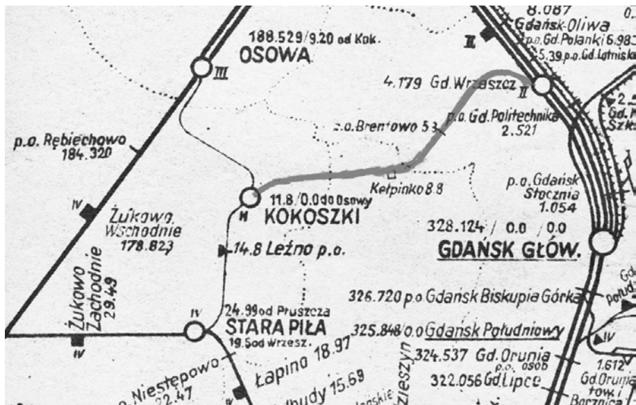
Fragment schematu sieci kolejowej z 1959 r. z zaznaczonym grubą szarą linią przebiegiem odcinka Wrzeszcz – Kokoszki
